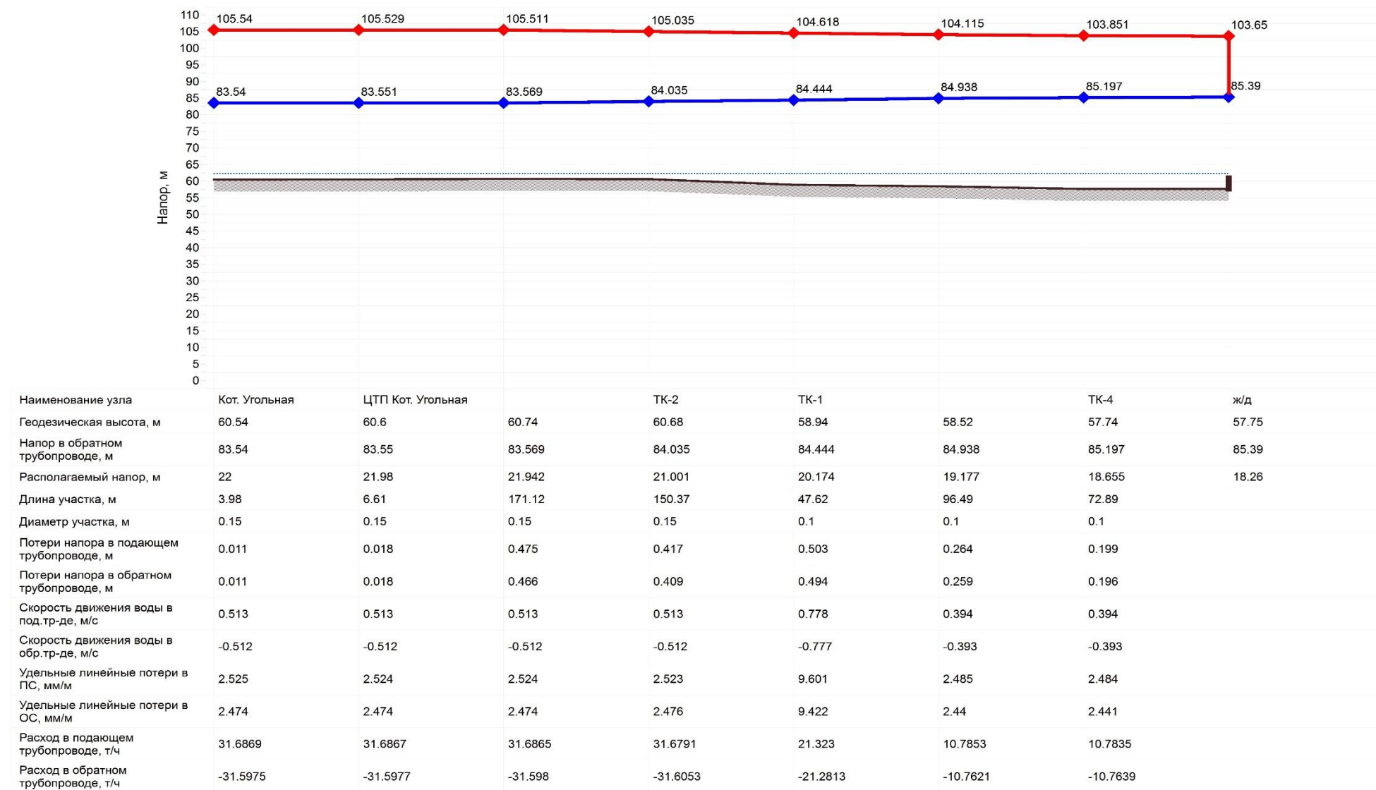
Рисунок 1.58. Пьезометрический график Угольная котельная — ул. Смирнова, 16
