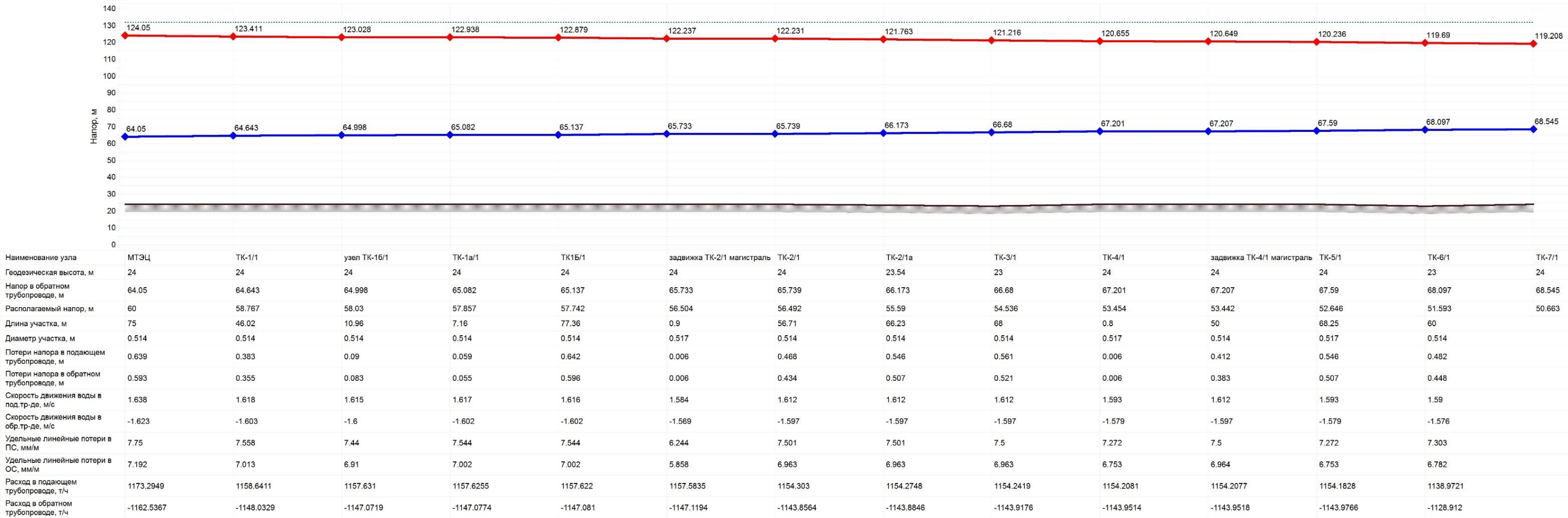
Рисунок 1.2. Пьезометрический график Мурманская ТЭЦ – ЦТП 34 кв.
