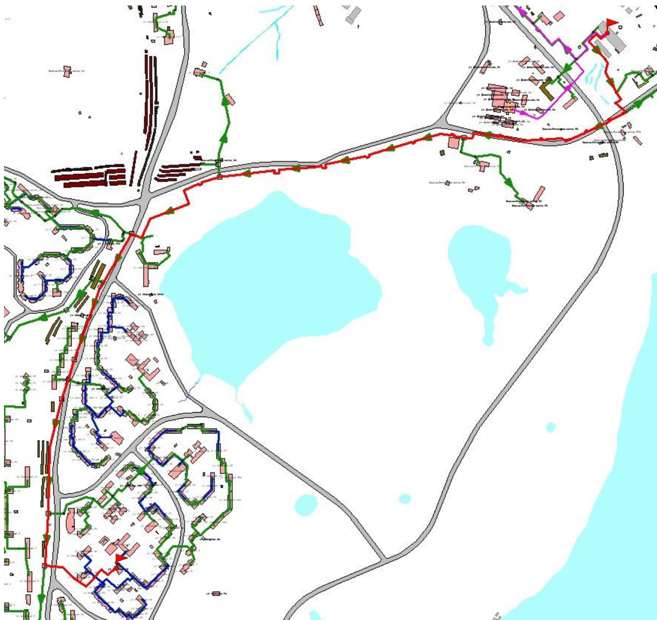
Рисунок 1.37. Путь построения пьезометрического графика Восточная котельная –ЦТП №1
